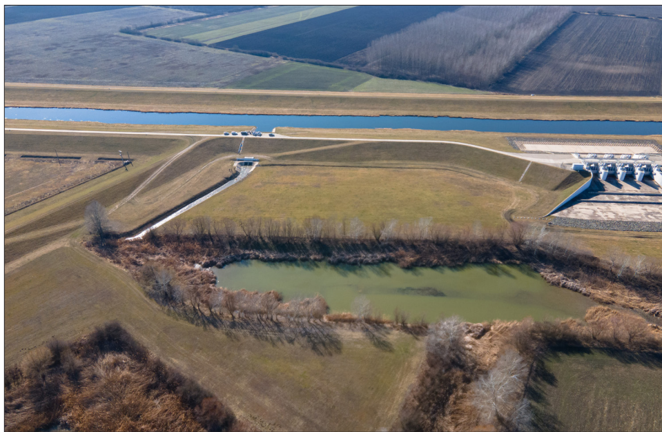
Vízpótlás a Kisdelta árvízi szükségtározó vízviSSzavezető műtárgyán keresztül, a Fekete- és Fehér-Körös közti területeken
